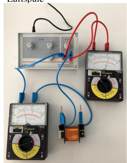
Spule mit Eisenkern
