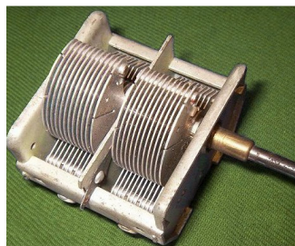
Drehkondensator zur Einstellung der Resonanzfrequenz
