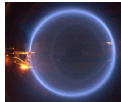
Elektronenbahn in der Fadenstrahlröhre
